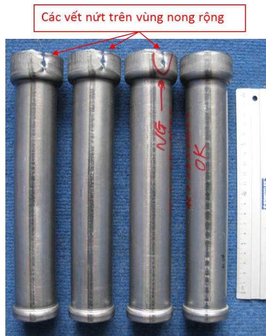
Hình 8. Chi tiết trên xe máy bị nứt trong quá trình gia công
