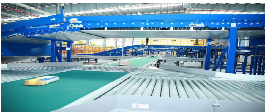
Ảnh: Hệ thống dây chuyền khai thác chia chọn tự động của Trung tâm VCKV khu vực phía Nam
